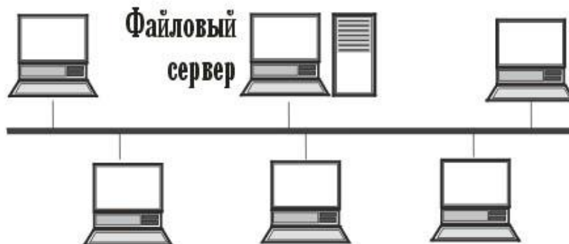
Рис. 5. Сеть шинной топологии
